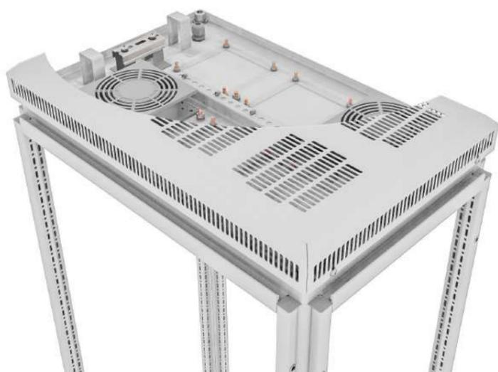
Панель вентиляторная RS52 предназначена для организации активной вентиляции. Устанавливается на месте стандартной потолочной панели линейных шкафов RS52 600x400 мм. Панель оснащена двумя вентиляторами серии FK6628.230.
