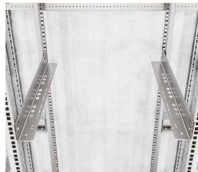
Монтажные шины 42x57 предназначены для монтажа 19-дюймового оборудования между передней и задней монтажными плоскостями в качестве опоры для тяжелого оборудования. Боковая системная перфорации обеспечивает боковую вентиляцию компонентов. Эффективная опорная поверхность - 51 мм.
