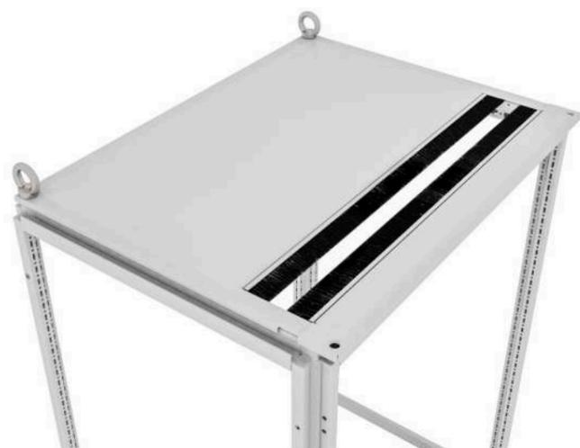
Панель потолочная с щеточным вводом двухсекционная RS52 устанавливается в замен серийной потолочной панели. Симметричная конструкция рамы RS52 может обеспечить ввод кабеля сбоку посредством поворота потолочной панели. Двухсекционное исполнение позволяет добавлять кабели после установки потолочной панели.
