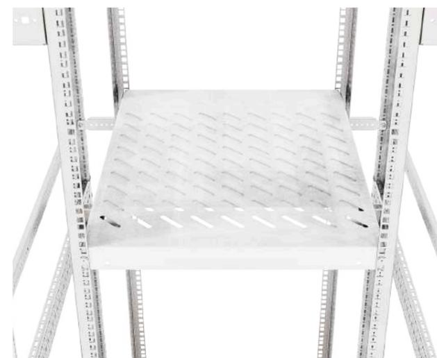
Полка для 19-дюймового оборудования с боковым креплением и регулировкой по глубине предназначена для монтажа на L-образные 19-дюймовые стойки шкафов RS52 на расстоянии от 600 до 900 мм между 19-дюймовыми стойками.
