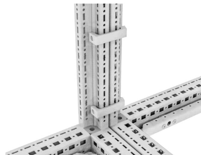
Комплект вертикальных соединителей применяется для соединения двух и более линейных шкафов RS52 на месте монтажа. Соединители устанавливаются на вертикальных стойках линейных шкафов RS52 методом стягивания двух стоек.
