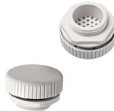
Клапаны компенсации давления применяются в корпусах, подверженным значительным внутренним и внешним перепадам температуры. При возникновении внутри корпусов отрицательного давления или вакуума, пыль и влажность может проникнуть внутрь шкафа через уплотнения съемных элементов.
