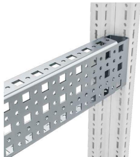
Планка ВМ монтажная тип К 23x73 предназначена для монтажа навесного оборудования при помощи резьбовых винтов с шагом 12,5 мм, клетьевых гаек и винтов с шагом 25,0 мм. Планка навешивается на наружный монтажный уровень рамы RS52, крепится при помощи специальных комплектов крепления планок. Монтаж оборудования осуществляется на внутреннем монтажном уровне.
