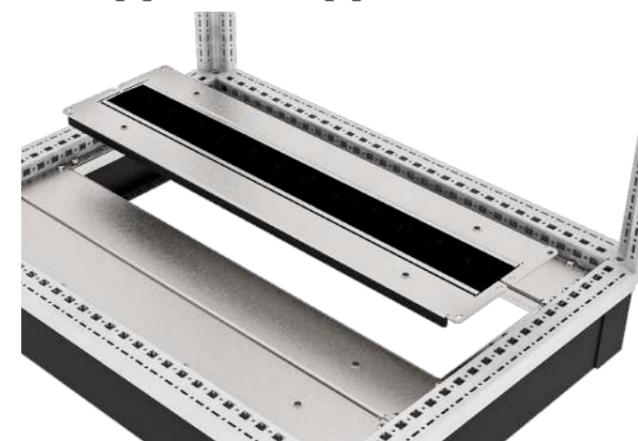
Панель с щеточным вводом средняя двухсекционная RS52 предназначена для монтажа групповых линий. Модуль с щеточным вводом шириной 200 мм заменяет комбинацию из двух стандартных панелей 100 мм RS52. Предусмотрена боковая и фронтальная установка.
