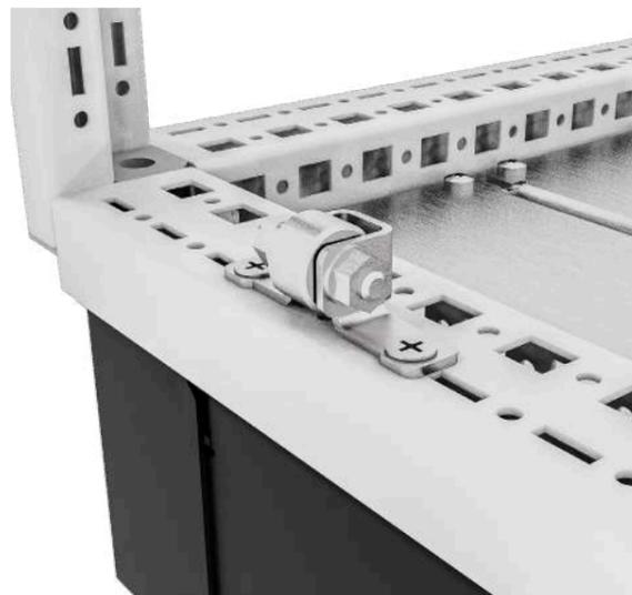
Ролик опорный двери RS52 предназначен для поддержки двери при наличии установленных тяжелых компонентов, таких как система вентиляции и кондиционирования. Служит для облегчения процесса заперения двери. Ролик крепится на раму основания, уголок упора крепится к нижней части профиля двери.
