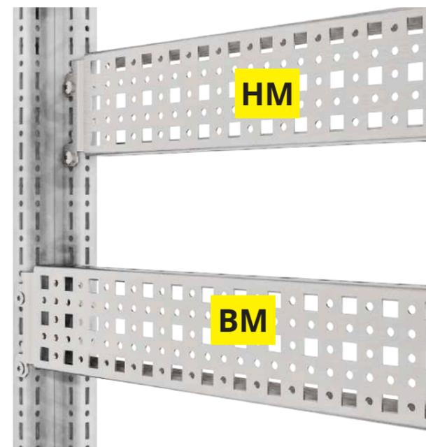
Планка монтажная ВМ и НМ 23x73 предназначена для монтажа навесного оборудования при помощи резьбовых винтов с шагом 12,5 мм, клетьевых гаек и винтов с шагом 25,0 мм. Планки навешиваются при помощи зацепов и крепятся на внутренний и наружный монтажный уровень рамы RS52.
