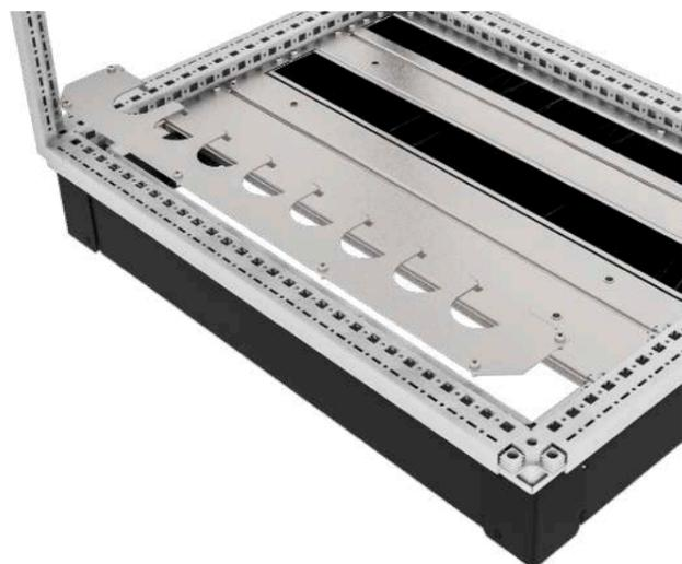
Панель кабельного ввода концевая 100 мм RS52 предназначена для организации кабельного ввода при помощи пластиковых гермовводов, позволяет выполнить позиционирование, соответствующее монтажу. Для повышения устойчивости проём основания при ширине 1000 мм и 1200 мм разделен на 2 части, который комплектуется совместно. Устанавливается вместо стандартной панели 100 мм RS52. Дополнительно необходимо приобрести кабельные вводы. Предусмотрена боковая и фронтальная установка.
