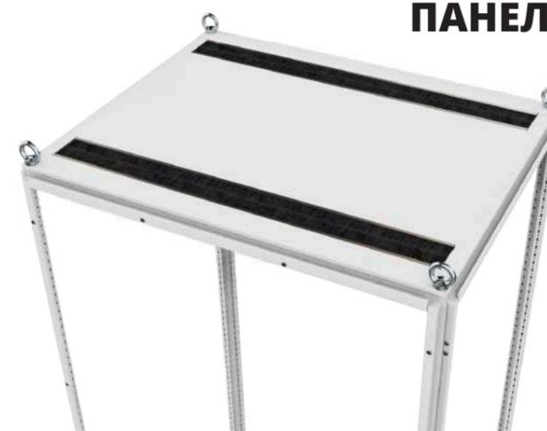
Панель потолочная с щеточным вводом трехсекционная RS52 устанавливается в замен серийной потолочной панели. Симметричная конструкция рамы RS52 может обеспечить ввод кабеля с боков посредством поворота потолочной панели. Двухсекционное исполнение позволяет добавлять кабели после установки потолочной панели.
