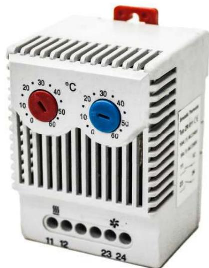
Терморегулятор совмещает в одном корпусе контакт нормально закрытый - для управления обогревателями, и контакт нормально открытый - для управления вентиляторами фильтрующими, оборудованием охлаждения и сигнальными устройствами. Степень защиты IP 20, номинальное напряжение 120, 230(AC), 24-72 (DC), частота тока 50/60.
