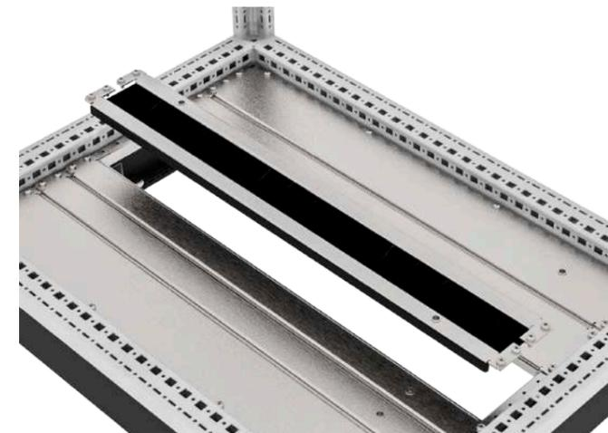
Панель уплотнения ПСУЛ средняя 100 мм RS52 двухсекционная предназначена для возможности монтажа кабелей групповых линий при помощи предварительно сжатой уплотнительной ленты ПСУЛ. Для повышения устойчивости проём основания при ширине 1000 мм и 1200 мм разделен на 2 части, который комплектуется совместно. Устанавливается в центре рамы. Предусмотрена боковая и фронтальная установка.
