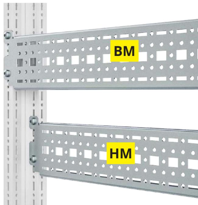
Предназначена для монтажа навесного оборудования при помощи резьбовых винтов с шагом 12,5 мм, клетевых гаек и винтов с шагом 25,0 мм.
