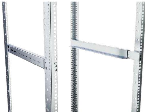
Монтажные шины 19x44x530-830 предназначены для монтажа 19-дюймового оборудования между передней и задней монтажными плоскостями. Предназначена для монтажа на L-образные 19-дюймовые стойки шкафов LC2/RS52 на расстоянии от 600 до 900 мм. между 19-дюймовыми стойками.
