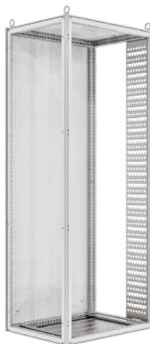
Кабельная трасса крепится между потолочной рамой и рамой основания каркаса высотой 2000 мм. Ширина трассы 200 мм. С системной перфорацией для крепления различных кабельных направляющих, а также с Т-образным держателем для кабельных стяжек.
