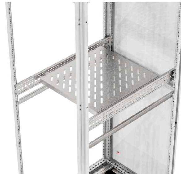
Полка приборная на раму RS52 предназначена для установки приборов различного назначения, размещения телекоммуникационного, электротехнического, лабораторного и прочего оборудования. Представляет собой плоскую платформу различной глубины. Установка осуществляется на планки внутреннего монтажа типа 17x73 или 23x73.
