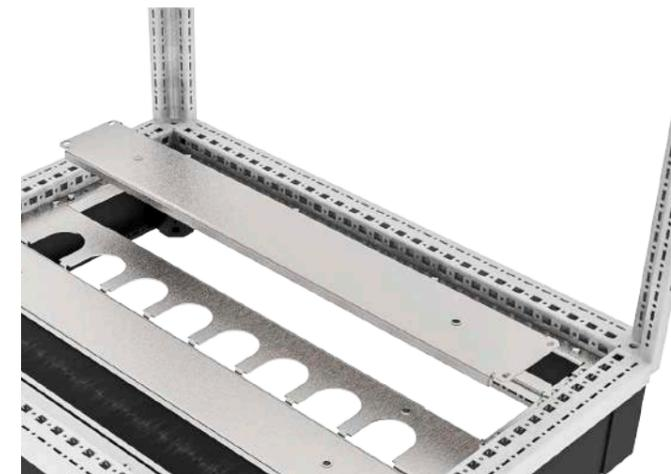
Панель основания глухая средняя 100/200 мм RS52 предназначена для закрытия основания шкафа, используется в комбинации с другими панелями соответствующей ширины. Для повышения устойчивости проём основания при ширине 1000 мм и 1200 мм разделен на 2 части, который комплектуется совместно. Устанавливается в центр рамы основания. Предусмотрена боковая и фронтальная установка.
