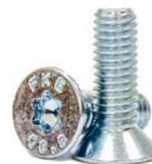
Винт M5x16 DIN 7500M TX резьбовыдавливающий с потайной головкой DIN 7500 M применяется при монтаже промежуточных боковых стенок линейных шкафов RS52. Такая конструкция позволяет винту самостоятельно создавать резьбу в металлических отверстиях.
