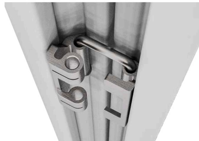
Комплект наружных соединителей RS52 применяется для соединения двух и более линейных шкафов RS52 на месте монтажа, при отсутствии возможности внутреннего соединения. Соединители устанавливаются на вертикальных стойках линейных шкафов RS52 в специально предусмотренных местах крепления петли и захвата запорного механизма.
