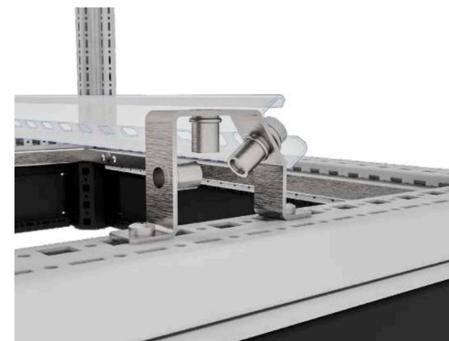
Комплект универсального крепления предназначен для установки L-образных шин и С-образных шин 30/15 на основание и монтажную панель шкафа RS52.
