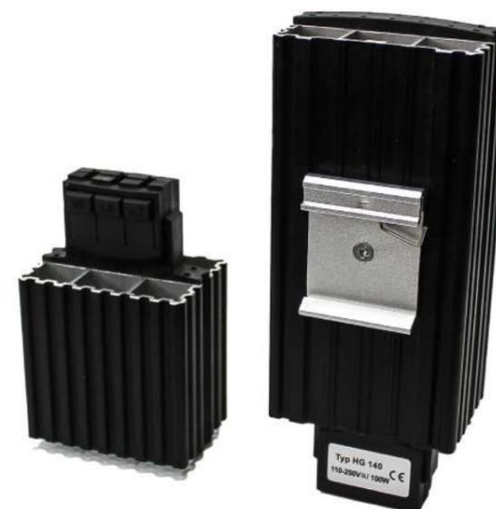
Обогреватели серии HG изготовлены из экструдированного анодированного алюминиевого профиля. Нагревательный элемент представляет собой сопротивление PTC типа, обладает функцией автоматической регулировки температуры. Монтаж осуществляется на стандартную DIN -рейку.
