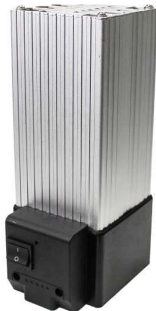
Обогреватели серии HG мощностью 250 и 400 Вт отличаются наличием вентилятора для рассеивания тепла и устройства автоматического отключения элемента обогрева в случае выхода из строя вентилятора. На панели управления имеется кнопка включения - отключения обогревателя.
