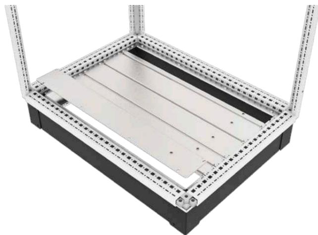
Панель основания глухая концевая 100/200/400 мм RS52 предназначена для закрытия основания шкафа, используется в комбинации с другими панелями соответствующей ширины. Для повышения устойчивости проём основания при ширине 1000 мм и 1200 мм разделен на 2 части, который комплектуется совместно. Предусмотрена боковая и фронтальная установка.
