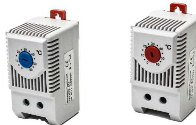
Термостаты серии КТО и КТС предназначены для управления устройствами поддержания микроклимата в шкафах RS52. Термостат КТО имеет нормально закрытый контакт и предназначен для отключения шкафных обогревателей в случае превышения заданной температуры в корпусах. Термостат КТС имеет нормально открытый контакт и предназначен для включения устройств вентиляции, охлаждения и сигнализации в случае превышения заданной температуры в корпусах. Монтаж устройств осуществляется на DIN-рейку.
